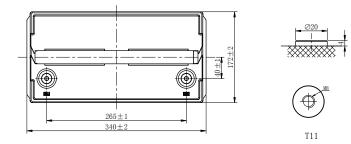
Note: Terminal Torque Values in-Ib(Nm):97.28-130.0(11.0-14.7)
