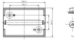
Note: Terminal Torque Values in-Ib(Nm):97.28-130.0(11.0-14.7)
